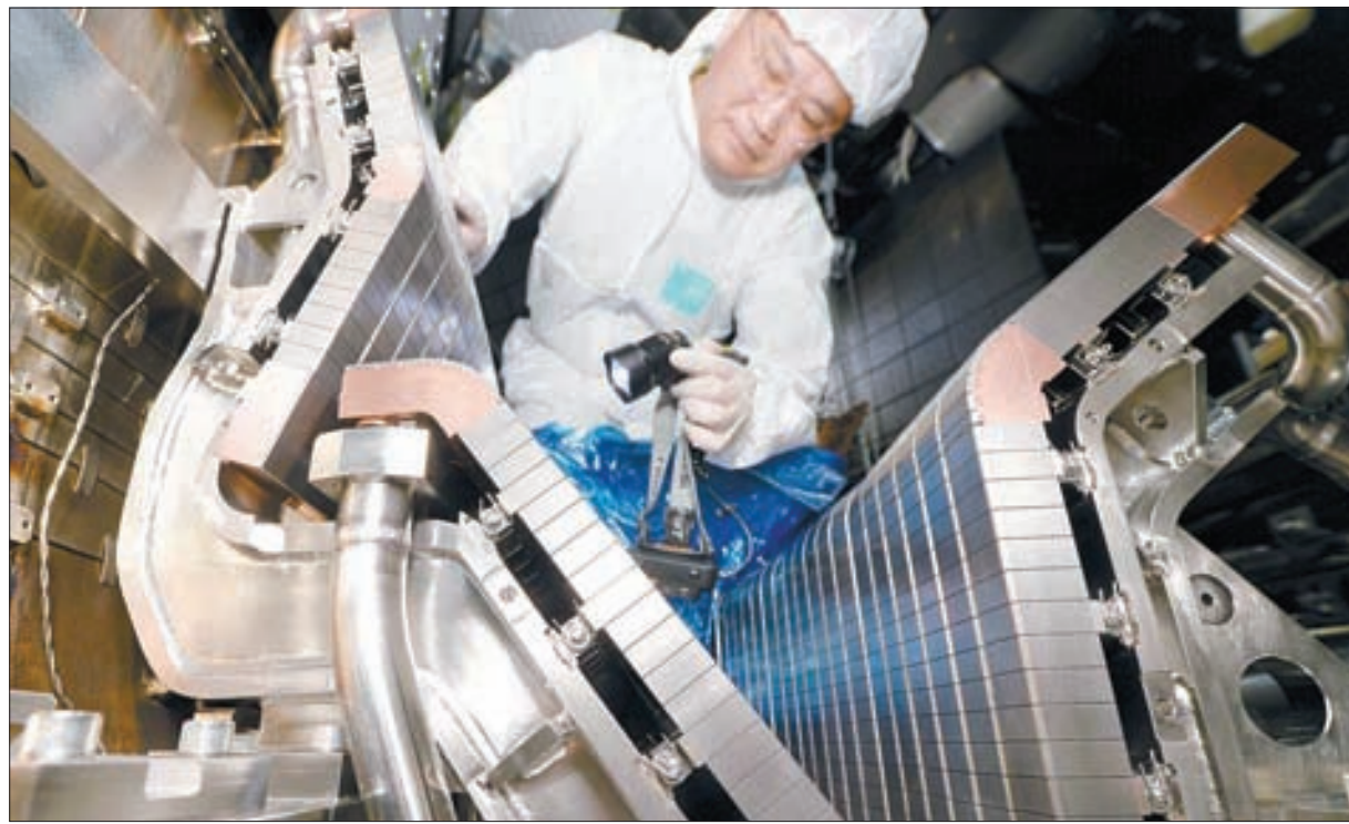
윤시우 한국핵융합에너지연구원 부원장이 KSTAR 내부 토카막에 새로 설치한 텅스텐 디버터를 점검하고 있다. 프리랜서 김성태
