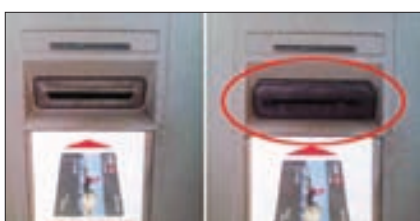
카드 삽입기 부분에 스키머를 덧씌운(오른쪽) 모습. [사진=뉴스웍스 커뮤니티 크레딧 유니언]
