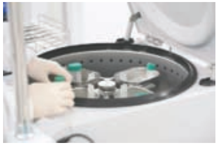
치료에 필요한 줄기세포 등을 수집할 때 이용하는 원심분리기. [사진 연세사랑병원]
