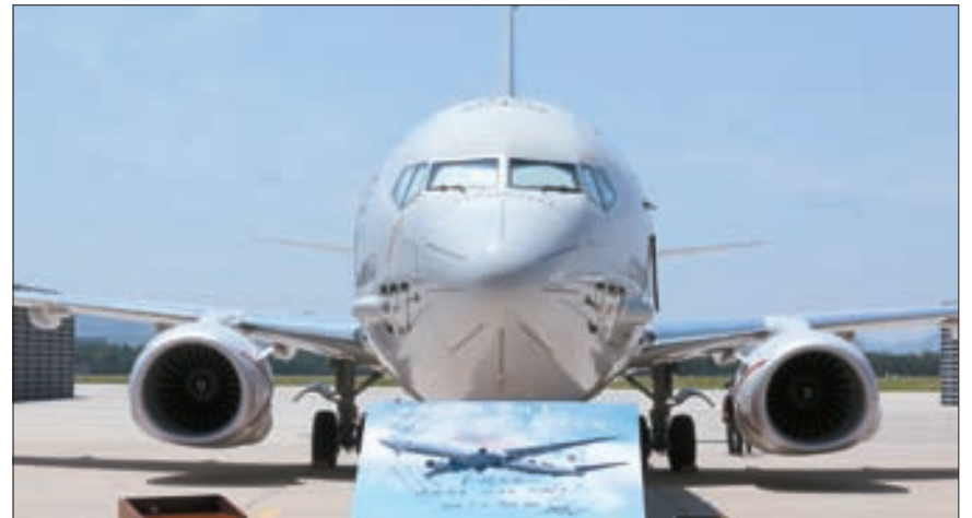
해군 ‘포세이돈’ 6대 인수 세계 최강의 해상초계기로 평가되는 미국 보잉사의 P-8A 포세이돈 6대 인수식이 4일 경북 포항시 해군항공사령부에서 열렸다. P-8A는 기체 길이 40m, 폭 38m, 높이 13m며, 터보팬 엔진 2개를 장착해 시속 900km 이상 속도로 비행할 수 있다. 바다 위를 빠르게 날며 적 잠수함을 찾아내 공격할 수 있어 ‘잠수함 킬러’라고도 불린다. 1년간의 전력화 훈련을 거친 P-8A는 내년 중반 작전에 투입될 예정이다. [사진공동취재단]
