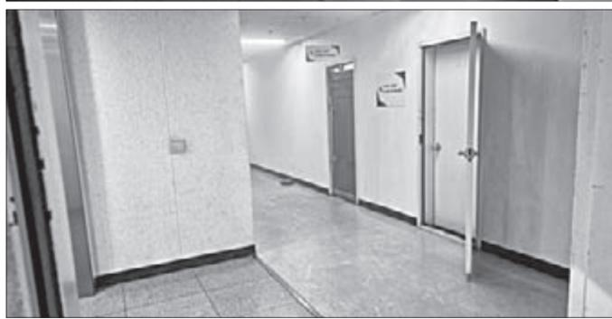
화재 당시 건물 2층(위 사진)과 5층 모습. 1층이 전소하면서 2층으로 불길이 번졌지만 닫힌 방화문으로 5층에는 연기 유입이 거의 없었다. [사진 경기도소방재난본부]
