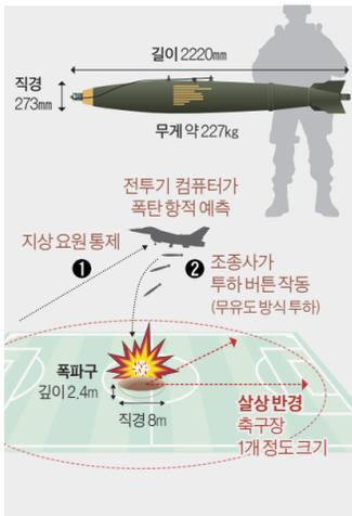
공대지 폭탄 MK-82(마크 82) 500파운드(227kg)급 범용 폭탄이다. 통상 87~88kg 트리톤날 폭약이 충전돼 있다. 건물, 시설, 교량 파괴 등에 주로 사용된다. 유도 기능이 없어 ‘멍텅구리 폭탄’으로도 불린다. 무유도 방식으로 투하되는 폭탄은 통상 일력된 좌표에 맞춰 조종사가 버튼을 눌러 투하하거나, 지상에서 요원이 통제하기도 한다. MK-82 투하 시 한 발당 직경 8m, 깊이 2.4m의 폭파구를 만든다. 폭탄 1개의 살상 반경은 축구장(7140㎡) 1개 정도 크기다. 1990년대 걸프전에서 미군이 사용하기도 했다.
