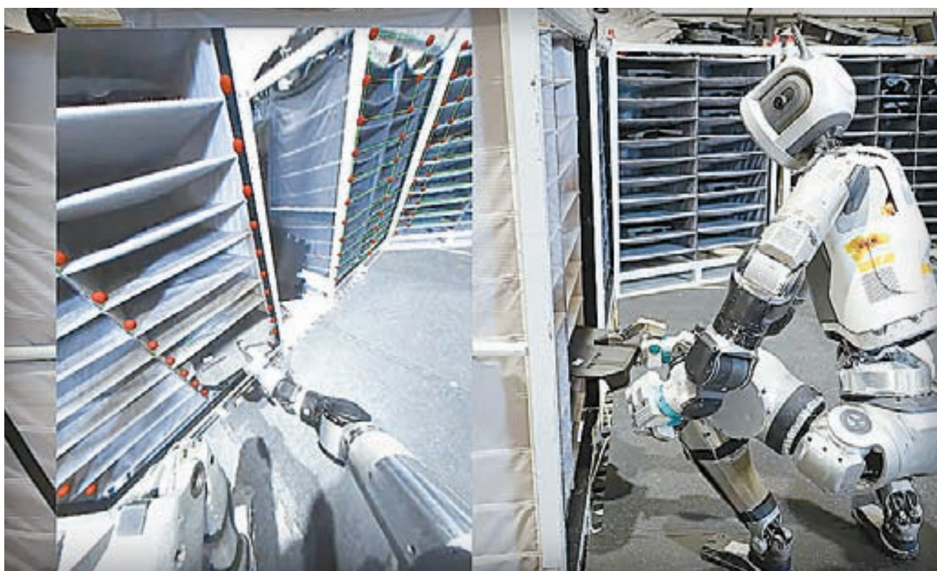
현대차그룹 로봇 전문 계열사 보스턴 다이내믹스의 휴마노이드 로봇 '올 뉴 아틀라스(All new Atlas)'가 생산 현장에서 스스로 작업하는 모습. [중앙포토]
